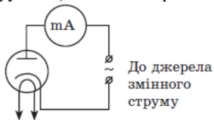
Рис.8.5. Використання вакуумного діода для перетворення змінного струму на пульсуючий
