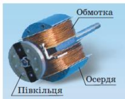
Рис. 11.5. Ротор двигуна (від латин. rotare — обертатися), який містить одну обмотку
