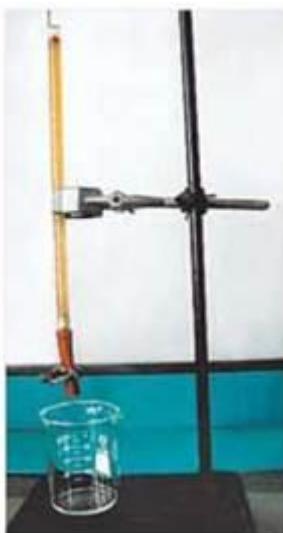
Мал. 75. Пом'якшення води в лабораторних умовах із використанням йонообмінної колонки
